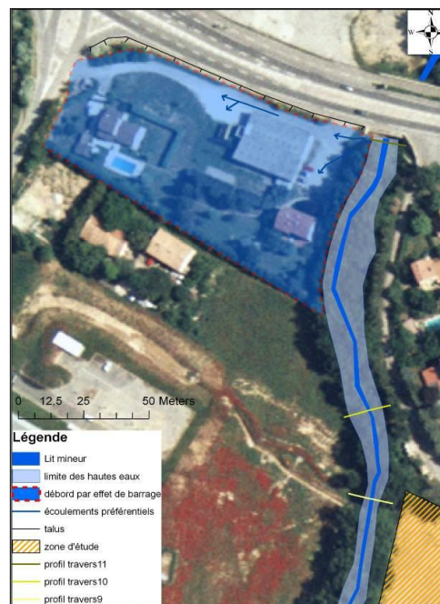
Carte de l'emprise des débordements du Verdalaï sur le secteur de la Corneirelle
